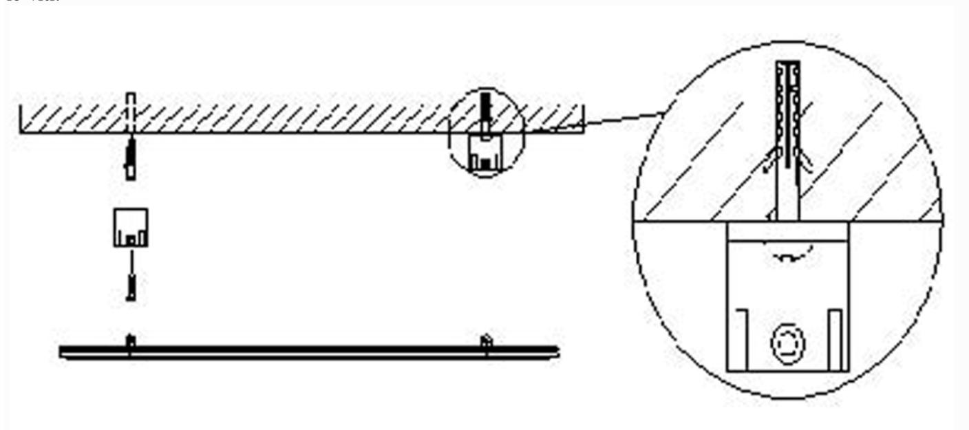
Fissare il pannello avvitando le viti.
